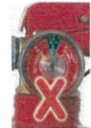
รูปที่ 2 เป็นอยู่ในเงื่อนไข "สีแดง" ด้านสายฉีดจะแสดงว่า "ถังดับเพลิงยังอยู่ในสภาพผิดปกติ" ต้องรีบทำการบำรุงรักษาถังดับเพลิงทันที
